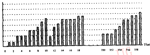
(b) 局部累加直方图 LCHI, 区间划分为 [10k, 10(k+1)] , k=0, 1, 2, \dots, 35 .
